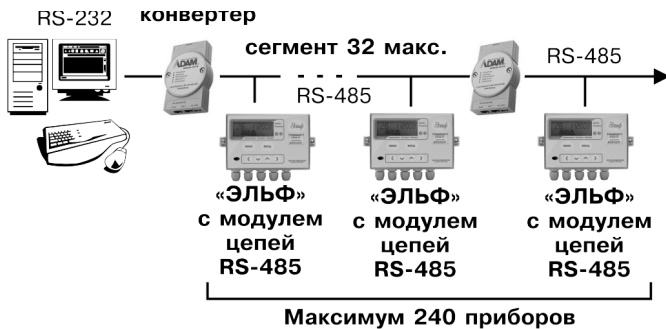
Рисунок 1.2 Варианты применения интерфейсного модуля RS-485
